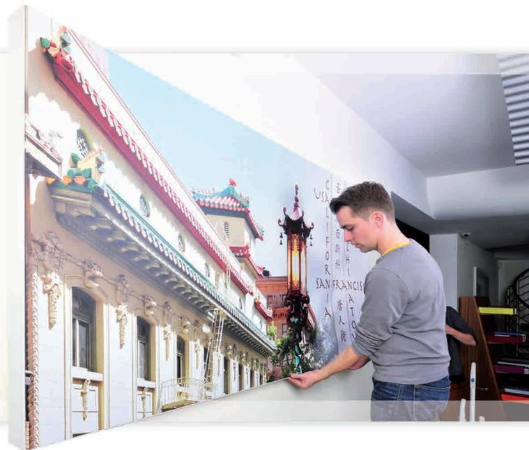
8. Die Plakate sind so gefertigt, dass sie unter leichter Spannung ans Rahmensystem angebracht werden. Durch die leichte Elastizität des Stoffes werden die Plakate faltenlos gestrafft. Der schnelle und unkomplizierte Austausch der Stoffbanner ist ein weiterer Vorteil dieses Produkts.
